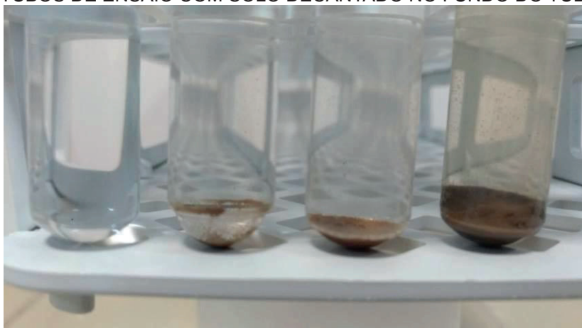
IMAGEM 17: TUBOS DE ENSAIO COM SOLO DECANTADO NO FUNDO DO TUBE DE ENSAIO
